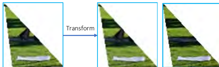
그림 4. 어파인 트랜스폼을 사용한 분할영역의 화소차 PSNR 비교 Fig 4. Segment PSNR calculation based on affine transform matching of stitched to reference triangle
