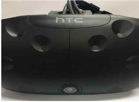
그림 4. 두부장착교시장치 Fig. 4. HMD(Head Mounted Display)
