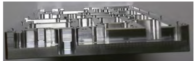
그림 5. 알루미늄 차폐 격자를 적용한 PCB Fig. 5. PCB with Aluminium Shield Lattice
