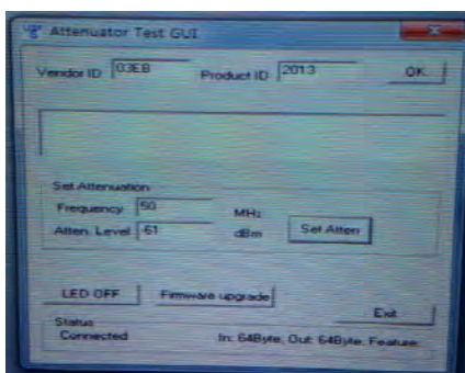
그림 9. 감쇄 레벨 조정 Fig. 9. Adjustment of Attenuation Level
