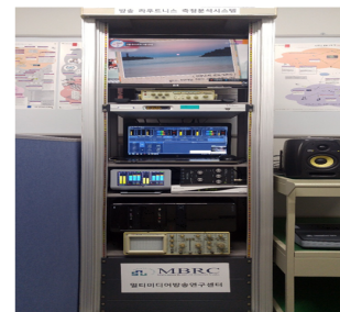
그림 4. 디지털텔레비전 음량 측정시스템
