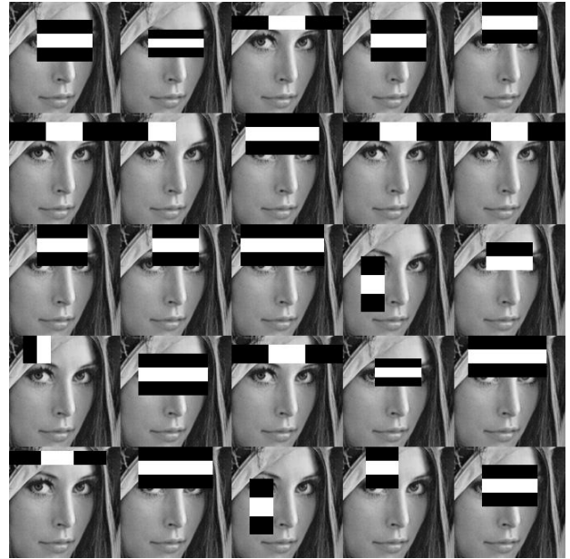
그림. 3. 다양한 Haar feature를 대조하여 얼굴을 검출하는 과정 [2] Fig. 3. Process of differentiating face detection through using various Haar features [26]
