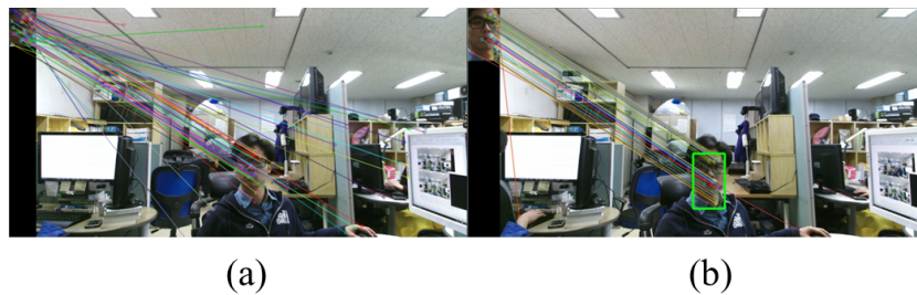
그림 10. (a) 여러 템플릿들과의 특징점 매칭 결과 (b) 호모그래피 변환으로 다시 찾은 추적 객체 Fig. 10. (a) Result from feature matching various templates, and (b) success in re-tracking the object through homography conversion
