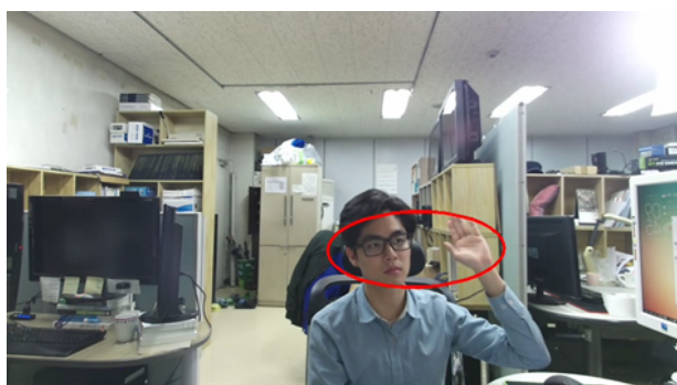
그림 5. 유사한 색상에 의한 불안정한 추적영상의 예시 Fig. 5. Unstable tracking in an image due to similar colors
