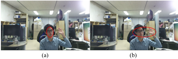
그림 7. (a) 깊이 정보를 사용한 개선 CamShift 알고리즘 결과 (b) 기존의 CamShift 알고리즘 결과
