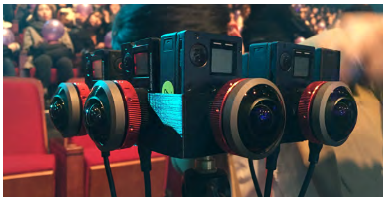
그림 6. 고프로 히어로4에 엔타니아 220도 렌즈를 장착한 VR 촬영 장치 Fig 6. VR shooting system with Entaniya Fisheye 220 and Gopro Hero4
