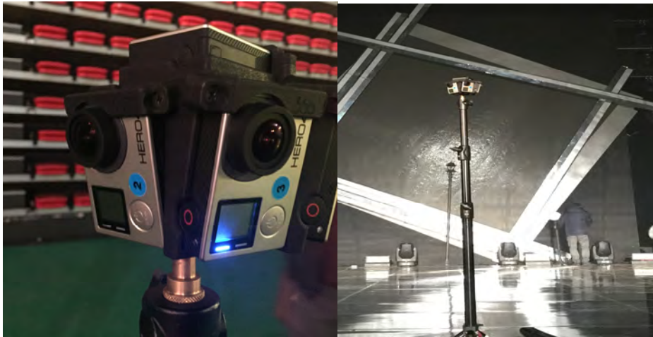
그림 1. 고프로 기반 VR영상 촬영 장치 Fig. 1. VR image capture system based on GoPro
