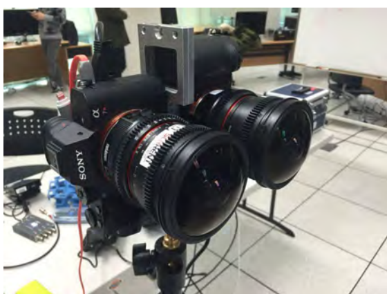
(a) 어안렌즈를 이용한 양안식 DSLR 촬영 시스템 (a) Stereoscopic DSLR VR shooting system using fisheye lens
