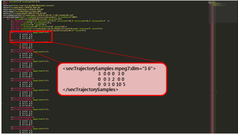
그림 5. (이진화 실험 예제 2) 한 개의 긴 이펙트 엘리먼트로 구성된 SEM 인스턴스 Fig. 5. A rigid body SEM instance composed of one huge effect element
