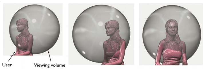
〈그림 8〉 사용자의 6DoF 움직임에 따른 시점 영상 재현 개념
