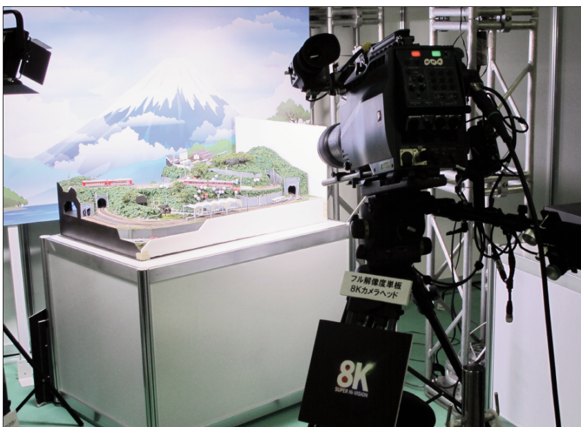
〈그림 II-11〉 풀해상도 단일 칩 8K 카메라 시스템 시연 장면
