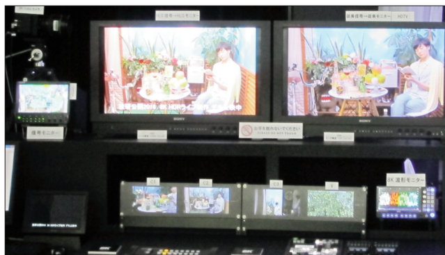
<그림 II-8> 8K+HDR 라이브 프로그램 제작 시연 시스템(각종 카메라는 사진 외부에 있음)
