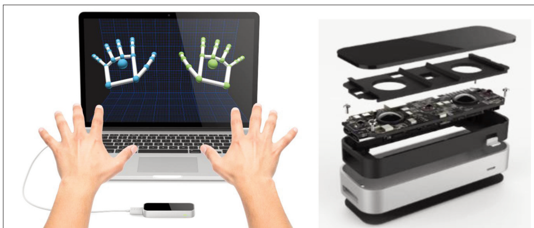
<그림 3> 립모션(Leap motion)을 통한 손가락 움직임 제어 예시(좌)와 립모션 카메라 구조(우)
