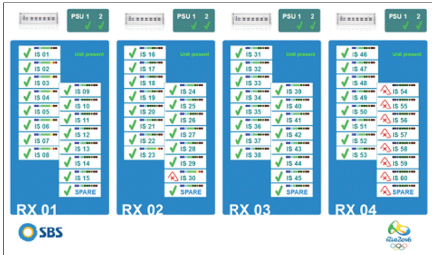
〈그림 8〉 SNMP 기반 IS Feed 상태 감시 환경
