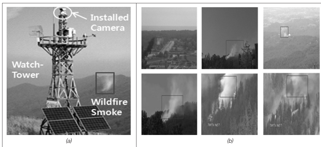
〈그림 4〉 카메라 기반 산불화재 감시를 위한 감시탑 (a) [9] 및 컴퓨터 비전 기술을 이용한 산불 감지 결과 (b) [10]
