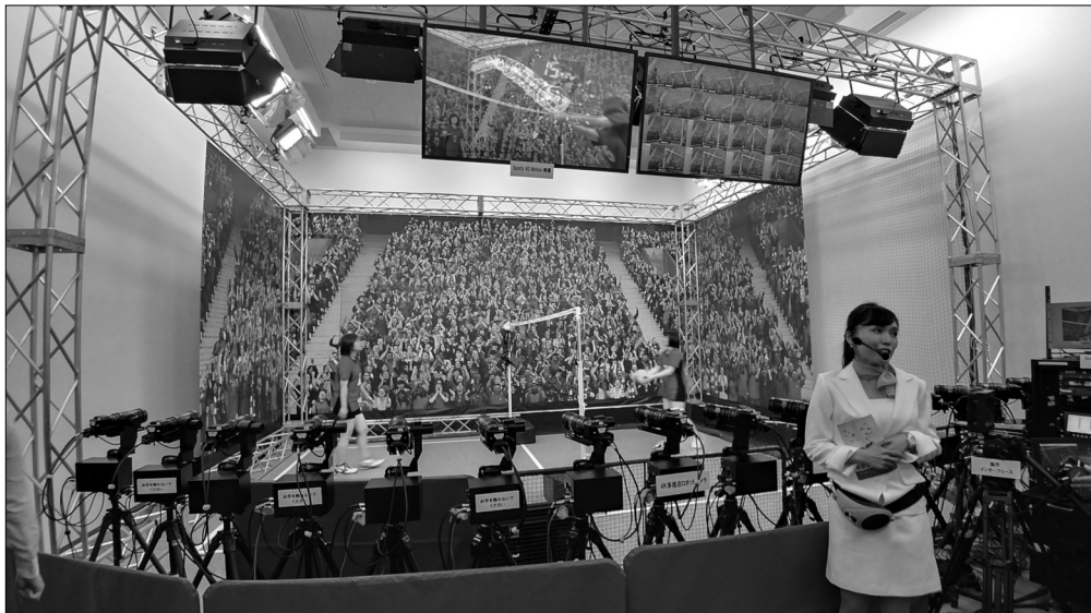
<그림 II-7-1> 16대의 로봇 카메라를 이용한 다시점 카메라의 촬영 장면
