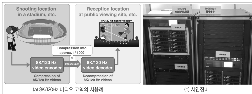
〈그림 IV-4-2〉 8K/120Hz 비디오 코덱의 사용례와 시연장비
