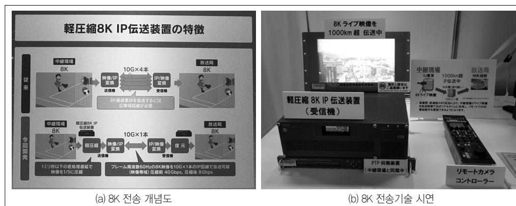
〈그림 III-4-1〉 IP 제작을 위한 8K 전송기술
