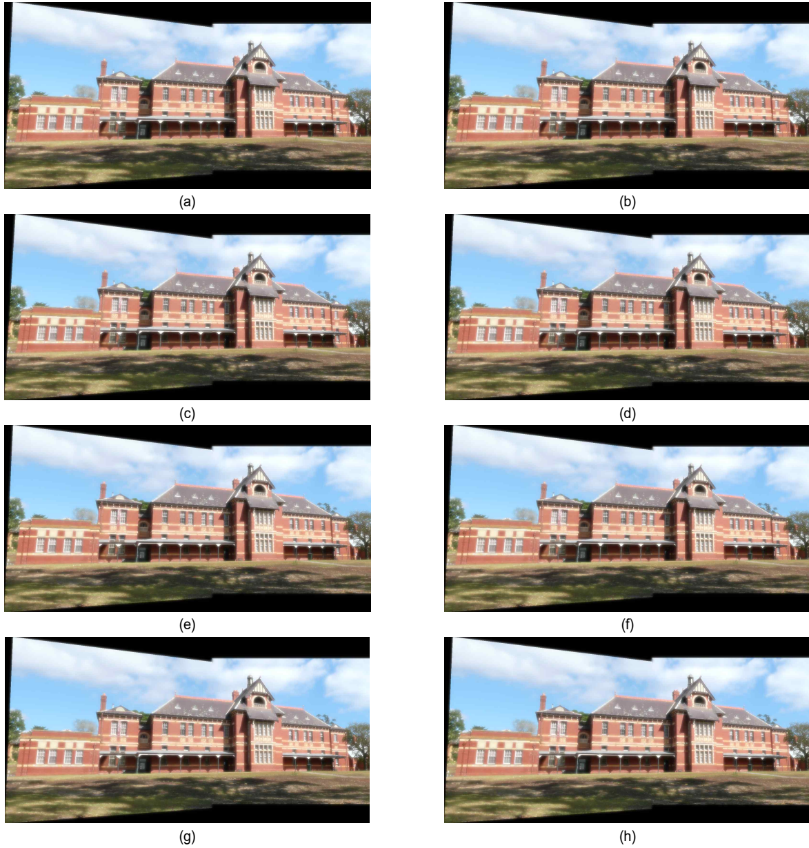
그림 12. \sigma 와 s 에 대한 스티칭 실험 결과의 예. Lowe 방식; (a) \sigma = 1.0 , s = 1 , (b) \sigma = 1.0 , s = 5 , (c) \sigma = 2.0 , s = 1 , (d) \sigma = 2.0 , s = 5 , Hess 방식; (e) \sigma = 1.0 , s = 1 , (f) \sigma = 1.0 , s = 5 , (g) \sigma = 2.0 , s = 1 , (h) \sigma = 2.0 , s = 5
