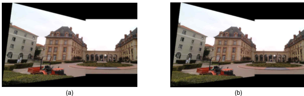
그림 6. 두 영상을 스티칭한 결과의 예; (a) Lowe 방식, (b) Hess 방식
