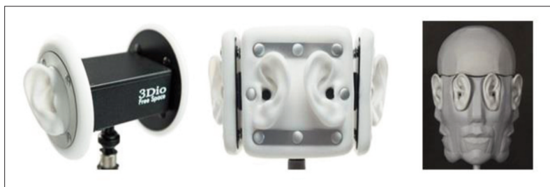
〈그림 6〉 바이노럴 오디오 획득을 위한 마이크론의 예
