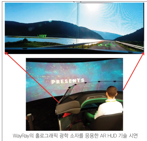
〈그림 11〉 WayRay사의 HOE 기반 HUD를 통해 나타나는 AR 영상(상), WayRay사의 HOE 기반 AR HUD 시연 시스템(하)
