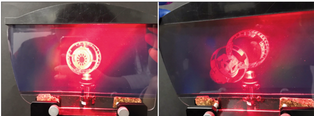
<그림 9> 돌출, 물입형이 공존하는 광 투과 홀로그램(조명광원 3cm로 설계 조사)
