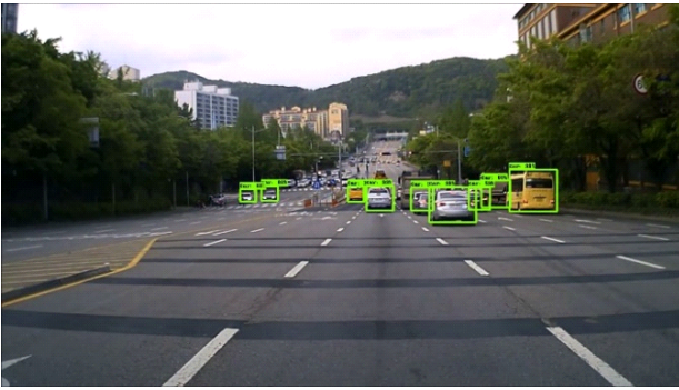
그림 6. 협각, 광각 카메라 데이터 학습 후 검출 Fig. 6. Detection image after learning the data from wide, narrow-angle
