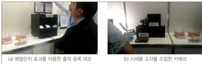
<그림 24> 유기 필름의 애벌란치 효과에 의한 출력 증가를 이용한 시제품 촬상소자와 카메라
