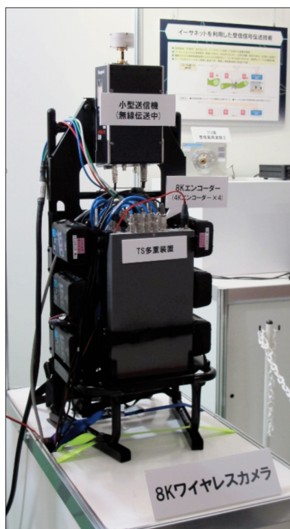
〈그림 32〉 8K SHV 무선 카메라의 송신 장치 시연 모습
