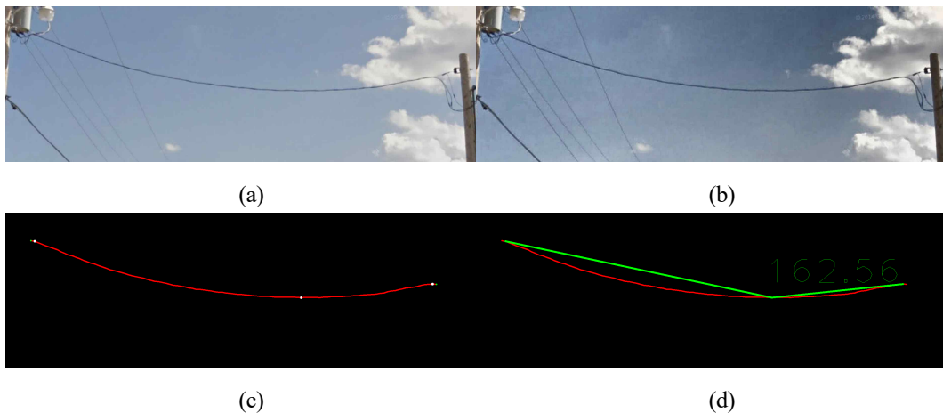
그림 9. 송전선 영상 전처리 후 각도 검출 기법: (a) Original Image (b) CLAHE를 적용한 이미지 (c) 제안한 방법으로 전선을 탐지 후, 0으로 마스크 한 이미지로 옮기고 양측의 최상단 점과 최하단점을 탐지한 이미지 (d) 그림 (c)에서 구한 각 점의 좌표와 아크 코사인을 사용하여 송전선 늘어짐의 각도 검출한 이미지
