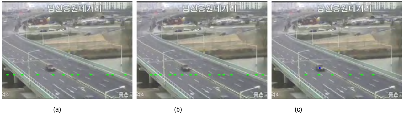
그림 7. 차로 중앙 지점 결과 예시 (a) 광류를 이용한 차로 중앙 지점 검출. (b) 배경 제거방법을 이용한 경우. (c) 심층 신경망 기반 객체 검출 방법을 이용한 경우
