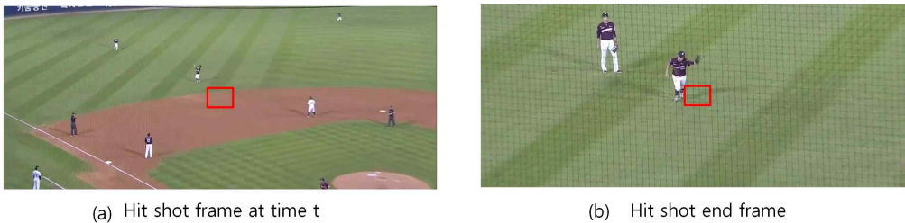
그림 7. 시간에 따른 중심 영역(빨간색)과 타구 위치 차이, (a) 프레임 밖의 공, (b) 마지막 프레임 Fig. 7. Difference between center region(red) and ball location over time, (a) Out of frame, (b) last frame
