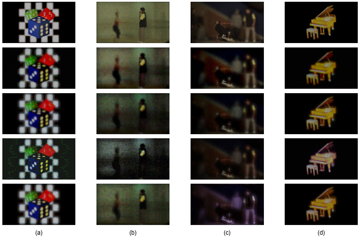
그림 11. 100:1 압축률에서의 압축 및 수치 복원한 결과 원본, H.264, JPEG2000, SPIHT, 제안한 방법 순서 (a) Dices1080p, (b) Ballet1080p, (c) Breakdancers1080p, (d) Piano1080p
