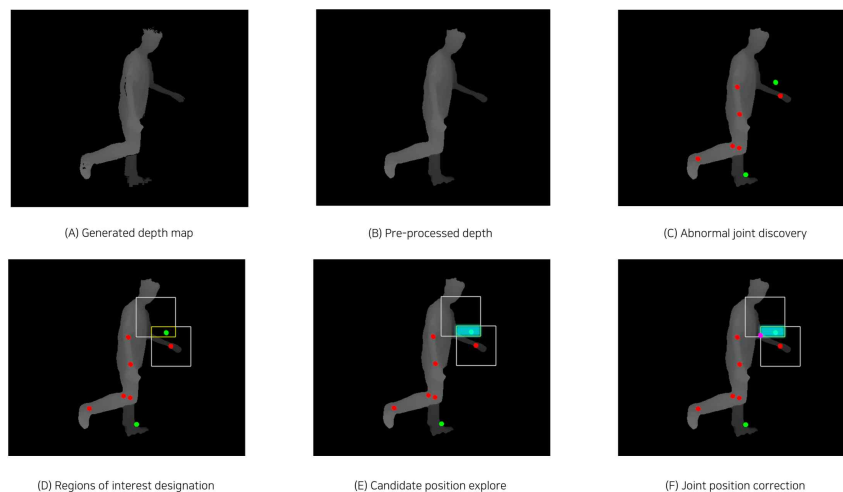
그림 6. BSL을 이용한 관절 보정 절차 Fig. 6. Joint correction procedure using BS
