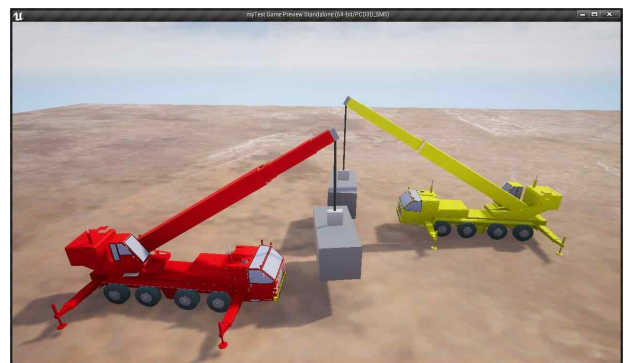
그림 6. Unreal 엔진 기반 크레인 충돌 시뮬레이션 Fig. 6. Collision simulation with cranes based on Unreal engine
