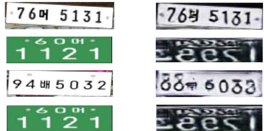
그림 11. 인조 이미지에 cycle-gan 적용 결과 Fig. 11. Results of applying cycle-gan to synthetic image
