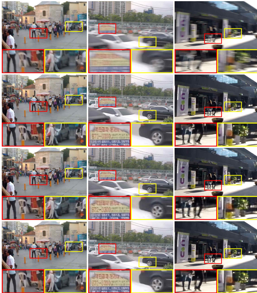
그림 3. 블러 제거 알고리즘의 비교. 위에서부터 차례대로 입력 블러된 영상, Nah et al [6] , ESTRNN(B9C80) [9] , 우리의 방법으로 블러를 제거한 영상 Fig. 3. Comparison of deblurring algorithms. Input blurred images, deblurred images with Nah et al [6] , ESTRNN(B9C80) [9] and our method shown sequentially from the top
