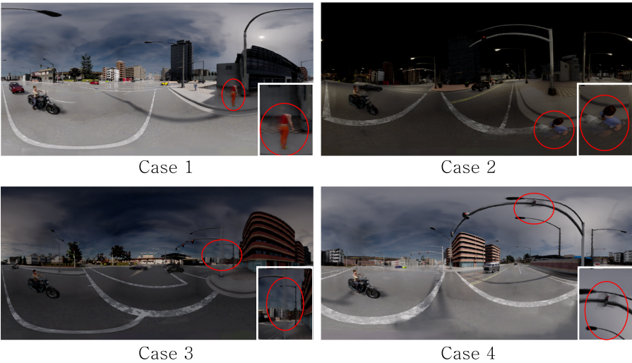
그림 10. 스티칭이 실패한 사례 Fig. 10. Cases of stitching failure
