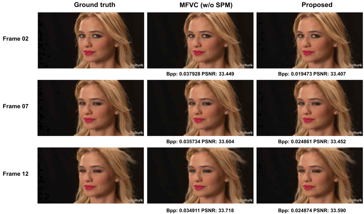
그림 5. UVG 데이터셋의 'Beauty' 비디오의 2번, 7번, 12번 영상을 압축 및 복원한 결과로, 제안된 모델은 PSNR 관점에서 화질 저하가 약간 존재하지만, 비트량을 크게 줄인 것을 확인할 수 있다
