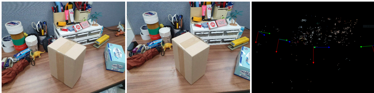
그림 2 입력 다중 영상(좌)에서 취득한 카메라 자세 및 point cloud(우) Fig. 2. Camera pose and point cloud (right) acquired from multi-view images (left)
