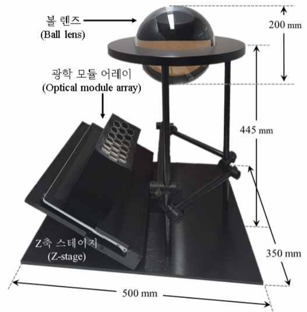
그림 9. 광학 모듈 어레이가 적용된 다시점 볼 렌즈 디스플레이 Fig. 9. Experimental setup of the multi-view ball-lens display with optical module array
