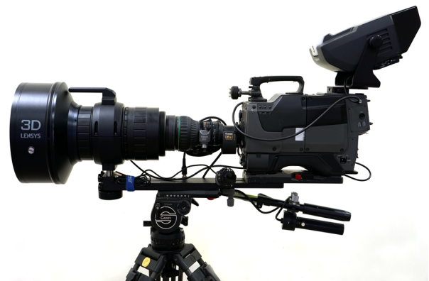
그림 4. 회전하는 셔터를 적용한 단일렌즈 양안시 카메라 시스템
