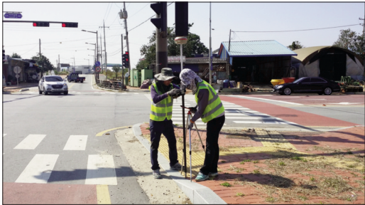
〈그림 5〉 지상기준점 취득을 위한 DGPS 측량
