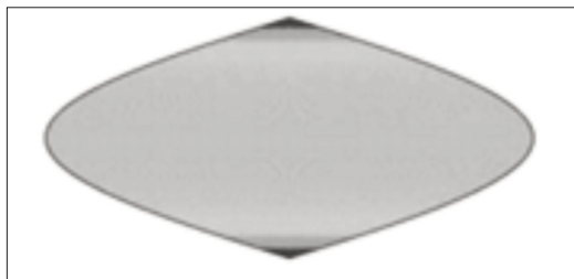
〈그림 6〉 CPP-PSNR을 위한 Craster parabolic 변환
