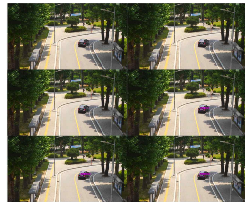
그림 10. Yolo v3 네트워크를 이용한 Video6 검출 결과 Fig. 10. Video6 detection result using Yolo v3 network
