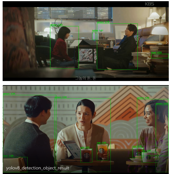
그림 2. YOLOv8 모델을 통한 객체 탐지 Fig. 2. Object Detection via YOLOv8 Model
