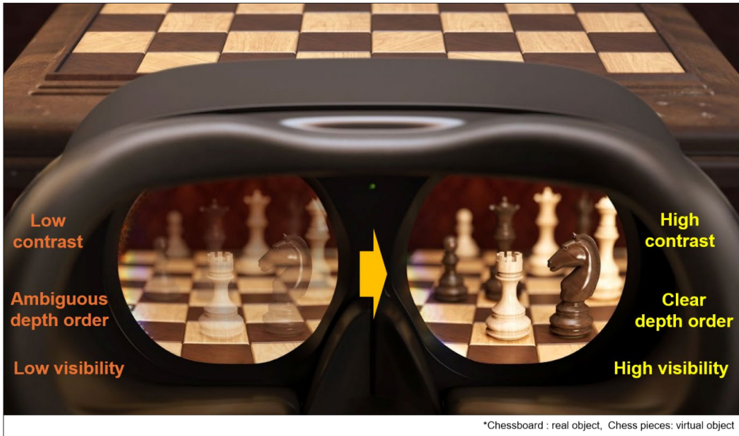
<그림 1> 광투과형 증강현실 근안디스플레이에서 실사 객체 폐색의 필요성. 기존 광투과형 증강현실에서는 디지털 영상이 실제 배경 위에 반투명하게 중첩되지만, 폐색 지원 증강현실에서는 디지털 영상 위치의 실사 배경 빛을 선택적으로 차단하여 높은 시인성과 명확한 깊이 순서를 제공할 수 있다.
