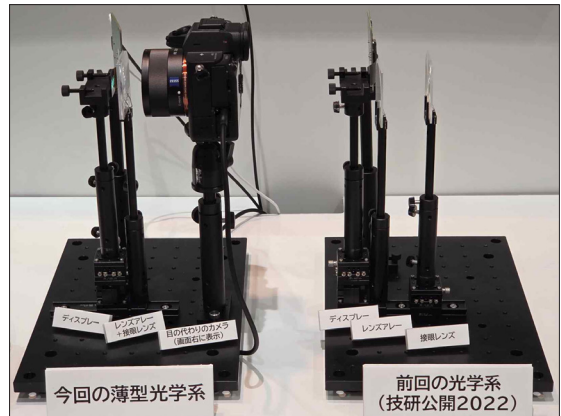
<그림 10-2> 과거의 두꺼운 광학계(좌측)에 비해 한층 얇아진 광학계(우측) (출처: NHK STRL Open House 2026)
