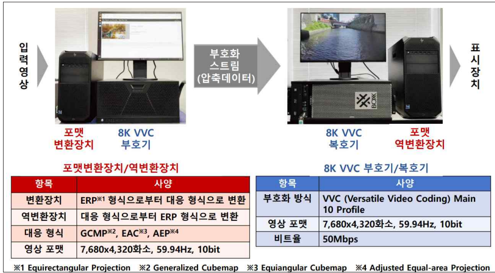
<그림 14-2> 전시된 8K 360도 비디오 부호화 장치 (출처: NHK STRL Open House 2026)
